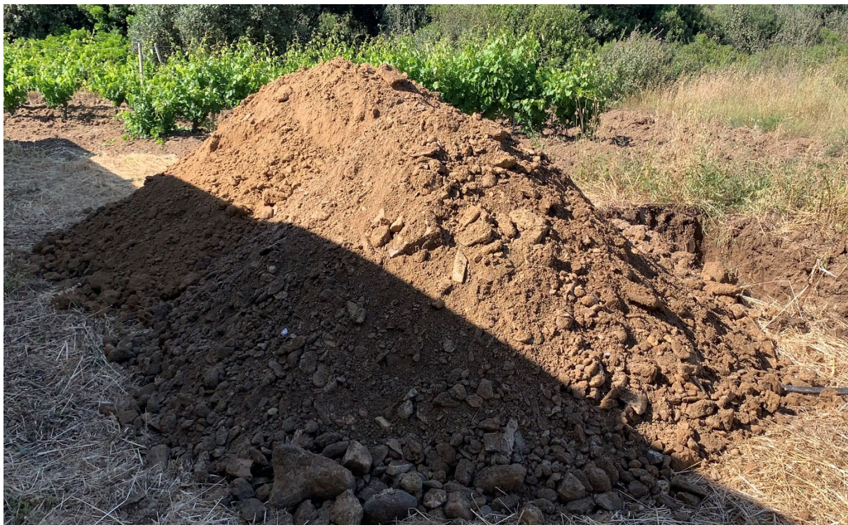
Fig.15: Ripresa fotografica del materiale estratto dal pozzetto geognostico P1
