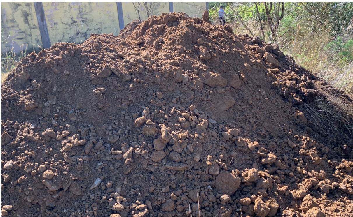
Fig.17: Ripresa fotografica del materiale estratto dal pozzetto geognostico P3
