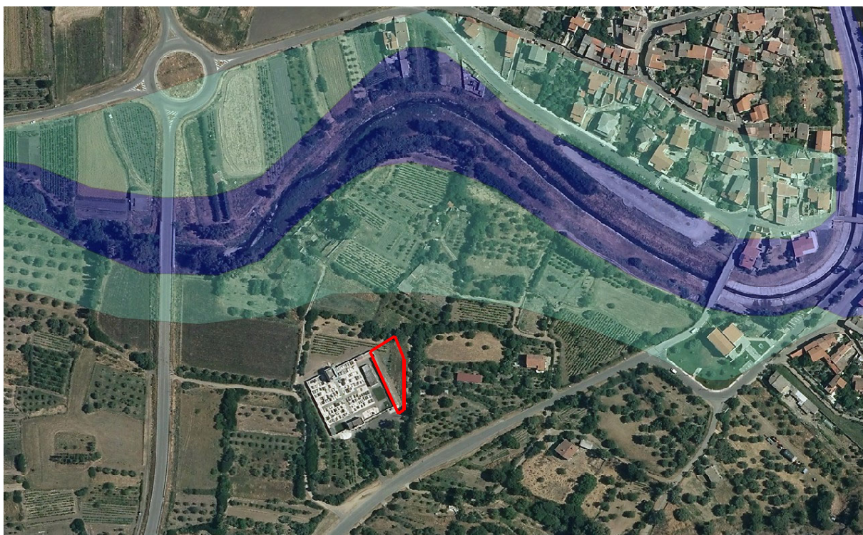
Fig.18: Stralcio cartografia della pericolosità idraulica PAI rispetto all'area d'intervento
