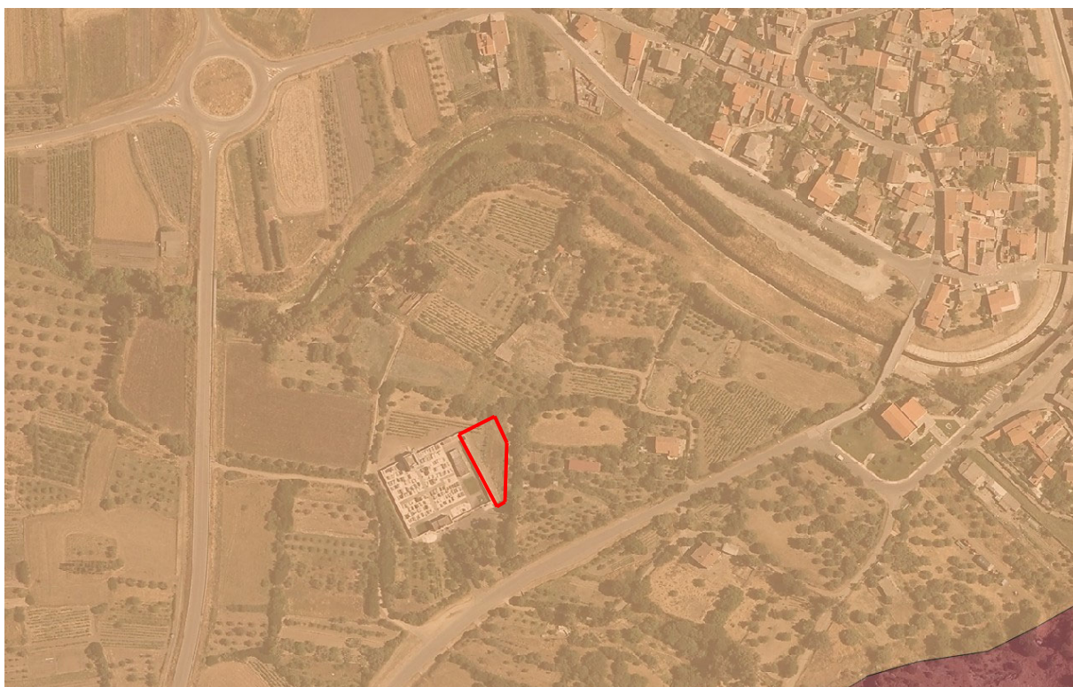
Fig.19: Stralcio cartografia della pericolosità da frana PAI rispetto all'area d'intervento (Zona a pericolosità moderata da frana Hg1)
