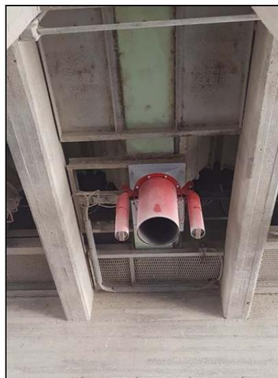
Figura 3 – Carico prodotti finiti sfusi – Particolare proboscide telescopica
