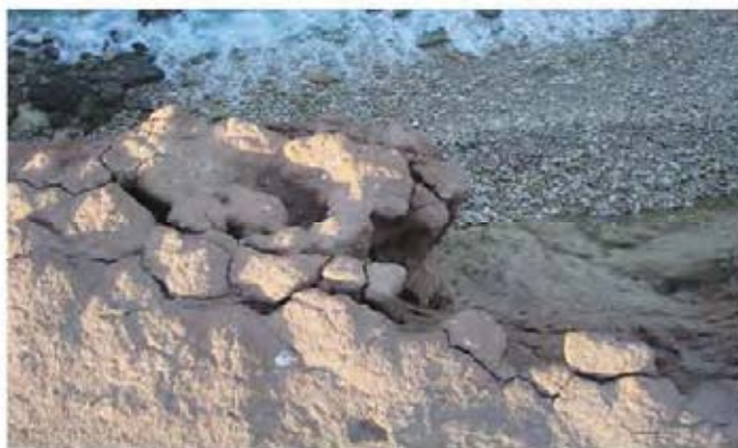
Figura 122 - fessure sulla superficie topografica in prossimità del ciglio della falesia, attraverso le quali si innescano consistenti infiltrazioni d'acqua meteorica entro la massa rocciosa, per porosità o entro di vuoti da dissoluzione ( karst )
