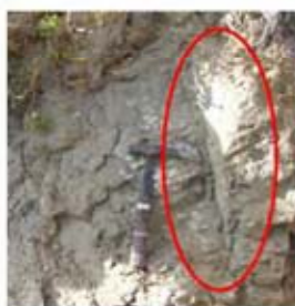
Figura 28 c - recenti crolli per collasso di mensole di arenarie di spiaggia M1 aggettanti sulle argille messiniane, osservati il 26 marzo 2009
