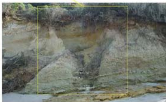
Colamenti di colluvi sulle sabbie plioceniche per fluidificazione da saturazione idrica -13 marzo 2009
