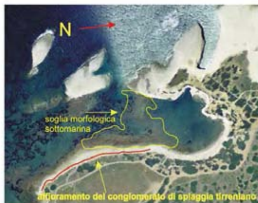
Figura 142 - il conglomerato di spiaggia del Tirreniano, poggia sulle sabbie continentali plioceniche e localmente su crostoni carbonatici arenacei preserva il versante da un efficace scalzamento alla base, rallentato anche dalla presenza di una piattaforma di abrasione incisa sul calcare marnoso-arenaceo.
