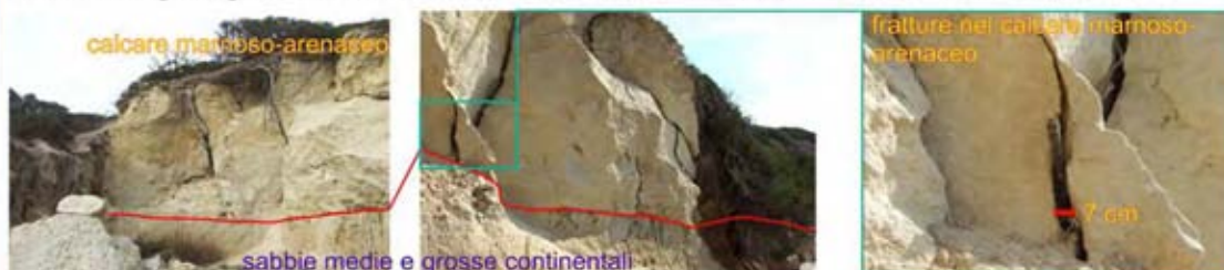
Figura 137 - (punto 2 di fig. 135): frane da crollo di blocchi calcarei marnosi esposti sulla ripa di erosione; Le due immagini registrano franamenti recenti, nel 6 novembre 2008, e l'ultimo nel 19 febbraio 2009.
