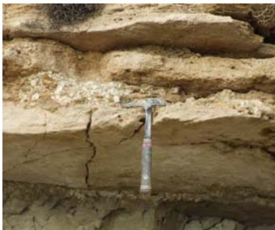
Fratture da carico nell'arenaria basale della sequenza di spiaggia M1
