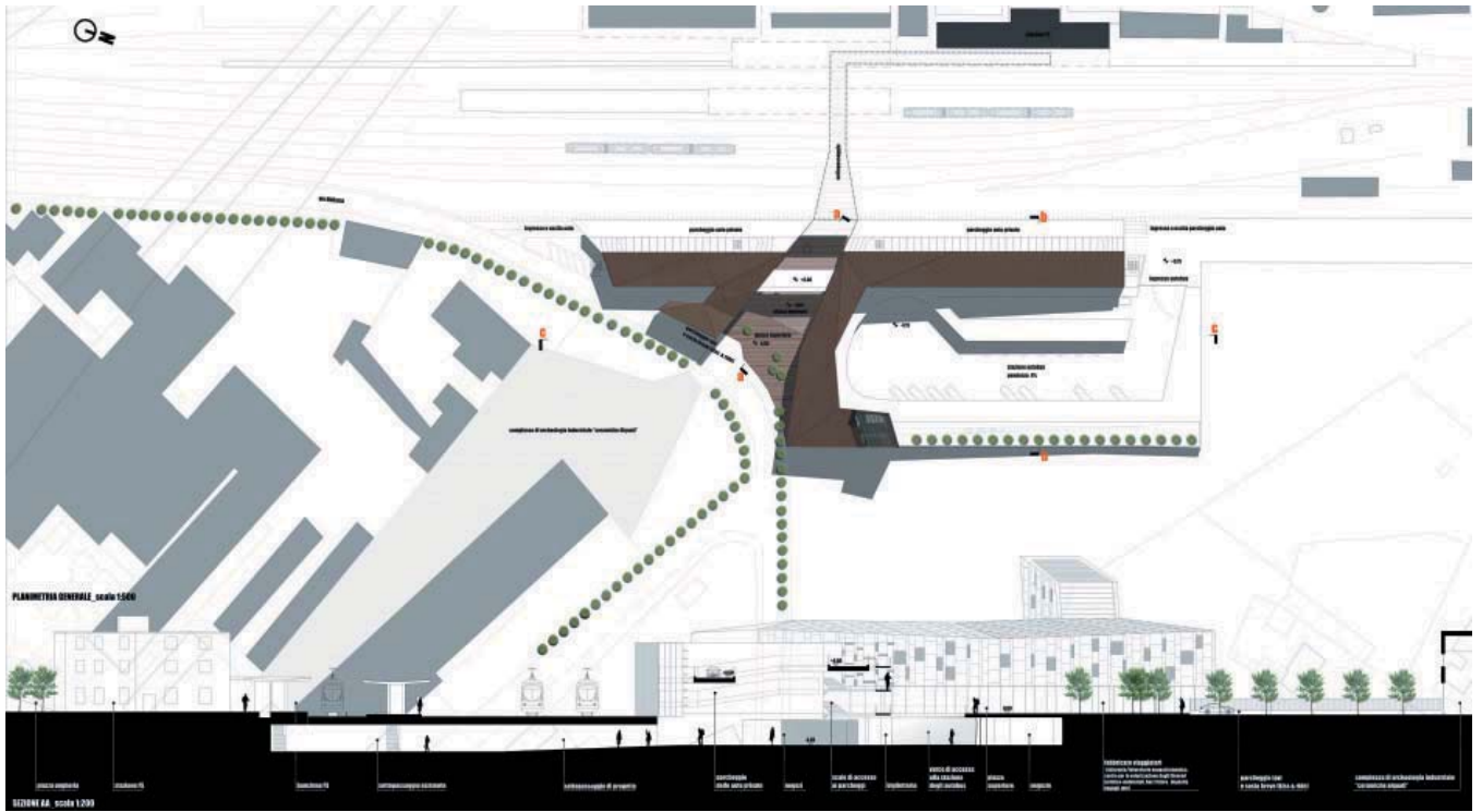
9_planimetria generale di progetto. Il terminal è suddiviso in due blocchi messi in relazione dalla piazza, nodo di connessione con la stazione ferroviaria
