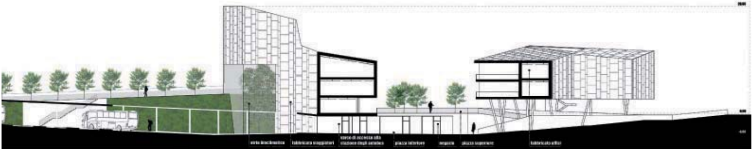
10_sezioni trasversali dei due blocchi del terminal, collegati tra loro attraverso lo spazio interrato
