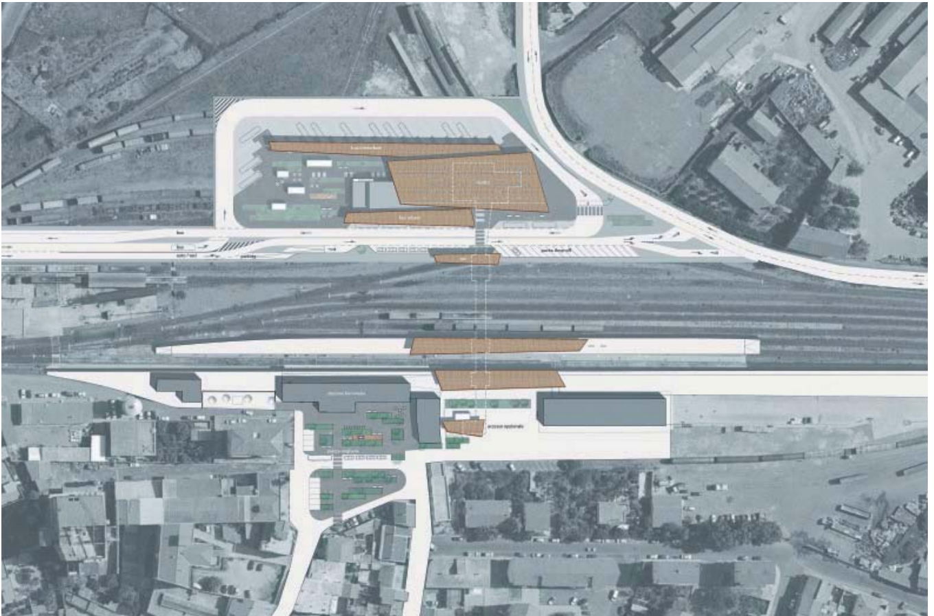
5_planimetria di progetto. Il centro intermodale stabilisce una relazione formale con la stazione dei treni attraverso la creazione di un sistema di pensiline
